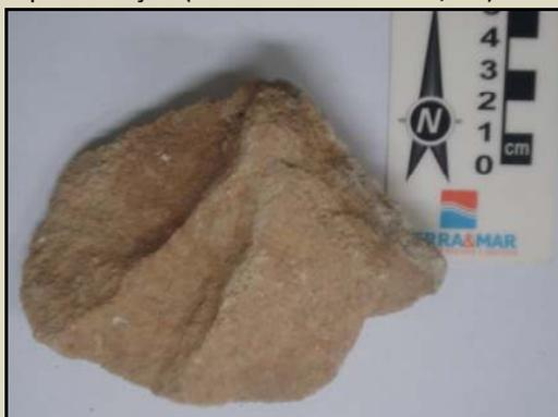
Figura 4.11 – Aspecto macroscópico da amostra de mão a partir da qual foi confeccionada a lâmina (Fonte: Marcos Nascimento).
