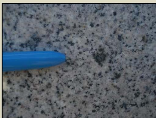
Figura 4.123 – Aspecto macroscópico do granito utilizado no revestimento do teatro (Fonte: Marcos Nascimento).
